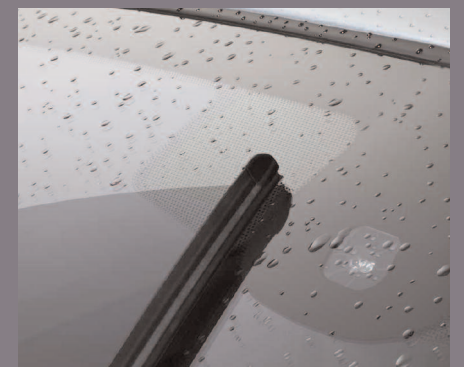
Limpa-vidros de accionamento automático através do sensor de chuva.
