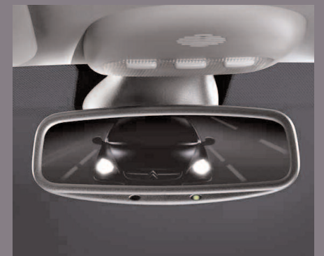
Para evitar qualquer risco de encandeamento: retrovisor electrocromado.
