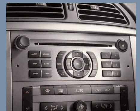
Sistema áudio com indexação do volume à velocidade.
