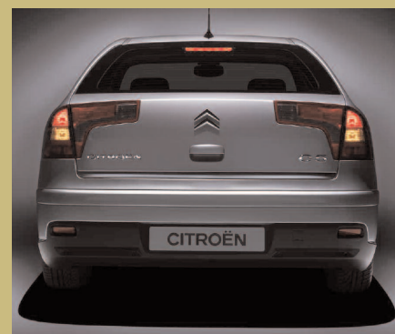
Ligação automática dos quatro piscas no caso de travagem de emergência.
