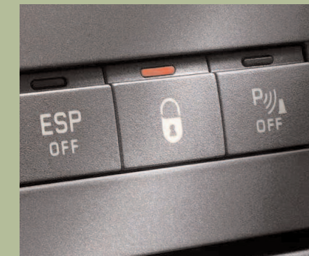
A partir dos 10 km/h, as portas trancam-se automaticamente.
